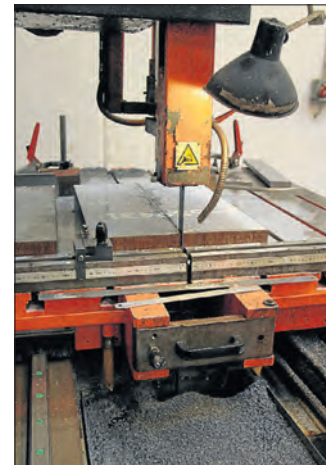
Som supplement til de to horizontale Behringer-save har La Cour & Faber en vertikal sav fra Frigg.
